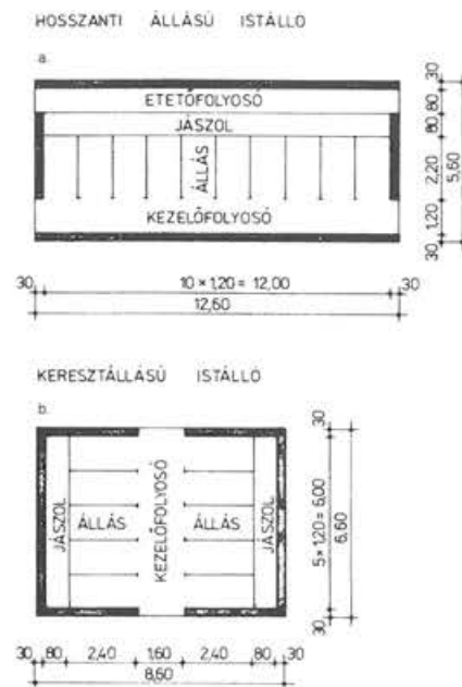
2.18. ábra. Hosszanti- és keresztállású istállóelrendezés.
